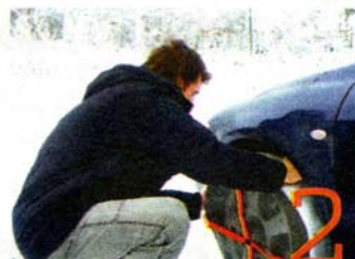
2 Bilen körs fram cirka en meter och reserande träs på. In i bilen och trampa på gasen – Autosock centererar sig själv.
